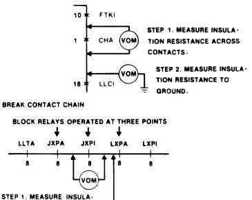
VOM STEP 2. MEASURE INSULATION RESISTANCE TO GROUND.
