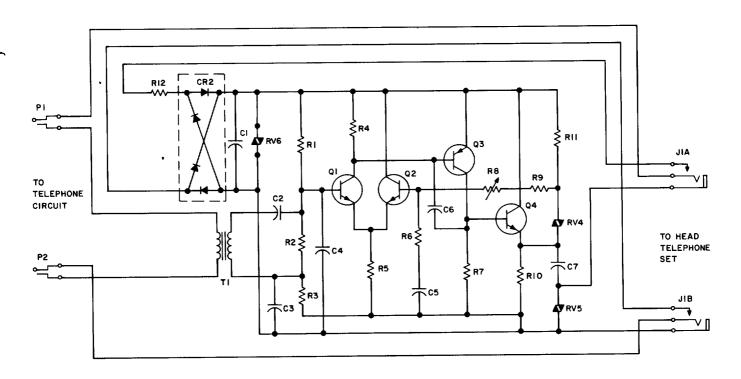
Fig. 3—292-Type Amplifier—Schematic
