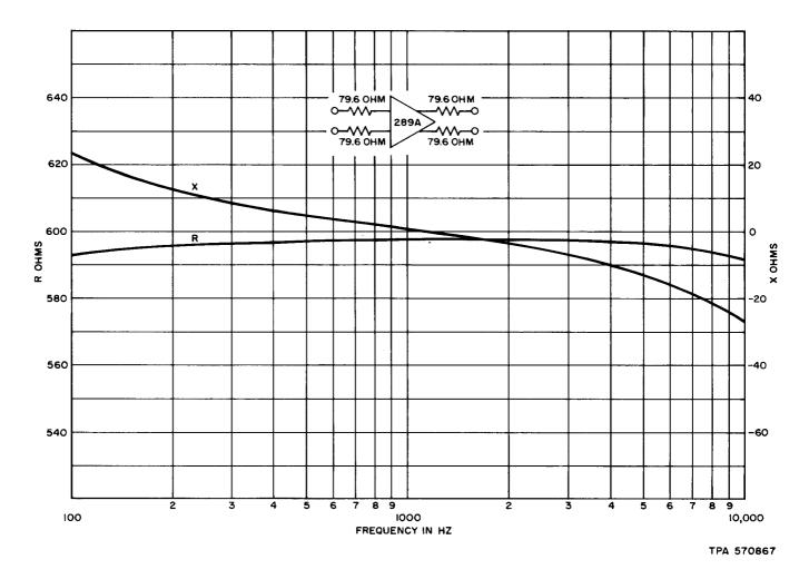
Fig. 4—289A Amplifier Output Impedance
