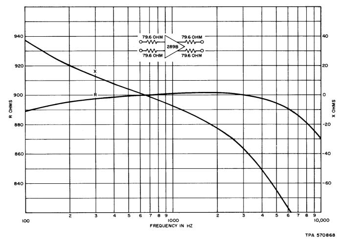
Fig. 5—289B Amplifier Output Impedance
