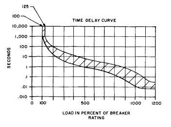
Fig. 2—Time Delay Curve Table A
