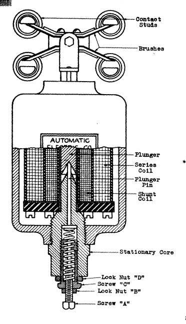
FIG. 1 CIRCUIT BREAKER DETAILS
