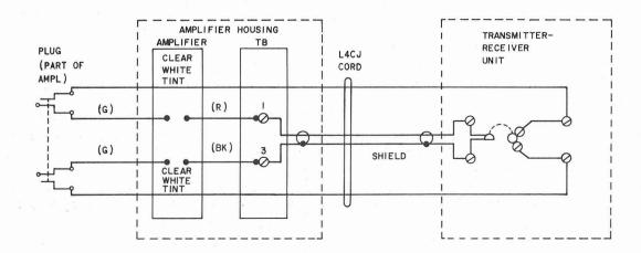
Fig. 7—280A Amplifier Connecting Diagram
