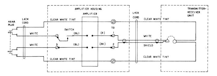
Fig. 8—281A Amplifier Connecting Diagram
