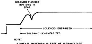
A NORMAL WAVEFORM IS FREE OF HIGH-VOLTAGE TRANSIENT SPIKES.
