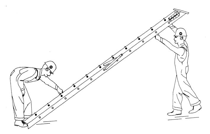
Fig. 5-Raising a Stepladder Over 8 Feet in Length
