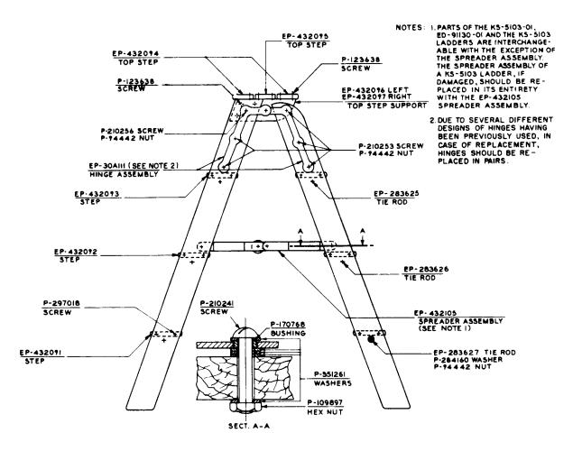
Fig. 5—4-Foot Portable Stepladder (See Note 1)
