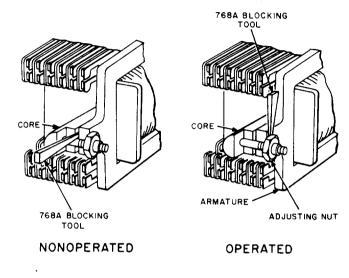
Fig. 7—Blocking U-, Y-, UA-, UB-, 271-, and 282-Type Relays
