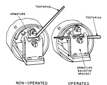
Fig. 17—Blocking 118-Type Relays
