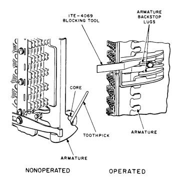
Fig. 25—Blocking 245-, 254-, 263-, and 264-Type Relays
