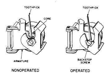
Fig. 26—Blocking 251- and 252-Type Relays
