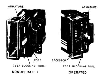
Fig. 8-Blocking AF-, AG-, AJ-, and AL-Type Relays
