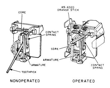
Fig. 6—Blocking L-, N-, and S-Type Relays
