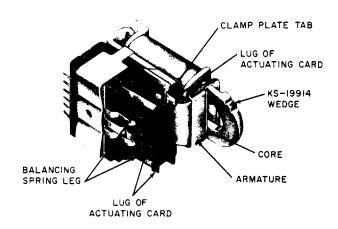
Fig. 11—Blocking BF-, BG-, BJ-, BL-, and BM-Type
