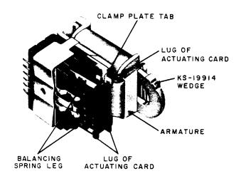
Fig. 12—Blocking BF-, BG-, BJ-, BL-, and BM-Type
