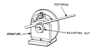
Fig. 14—Blocking 89-, 101-, 105-, 108-, and 172-Type Relays - Operated
