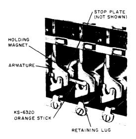
Fig. 31—Blocking 324-, 325-, 328-, 334-, and 338-Type Switch Holding Magnets - Nonoperated
