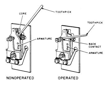
Fig. 20-Blocking 196-Type Relays
