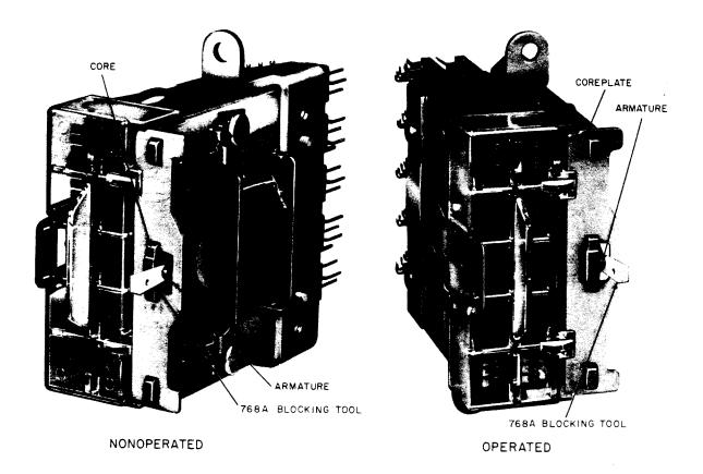
Fig. 10—Blocking 286-, 287-, and 288-Type Relays
