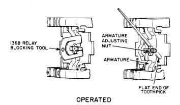
Fig. 2—Blocking Operated A-, AB-, E-, F-, H-, M-, R-, T-, 236-, 266-Type and EA1- through EA13-Type Relays
