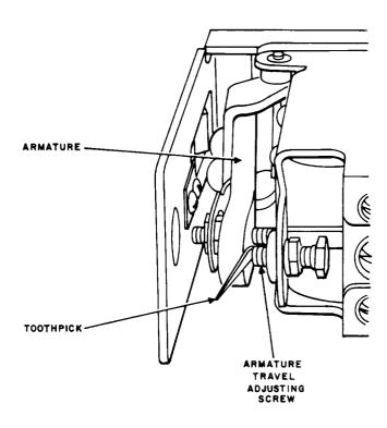
Fig. 24—Blocking 229-, 230-, and 232-Type Relays
