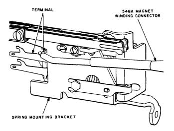
Fig. 7—Connecting to Winding Terminal of the Hold Magnet of the 300-, 301-, 302-, 303-, 304-, 305-, 306-, 307-, 308-, 314-, 315-, and 318-Type Switches
