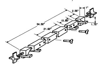
Fig. 3—819A Clamping Tool
