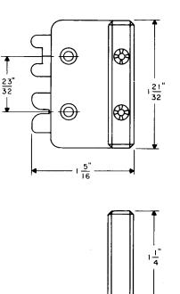
Fig. 5—471A Test Connector Tool
