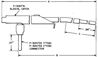
Fig. 14—770A Test Connector Tool
