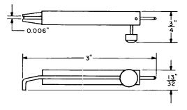
Fig. 3—419A Test Connector Tool
