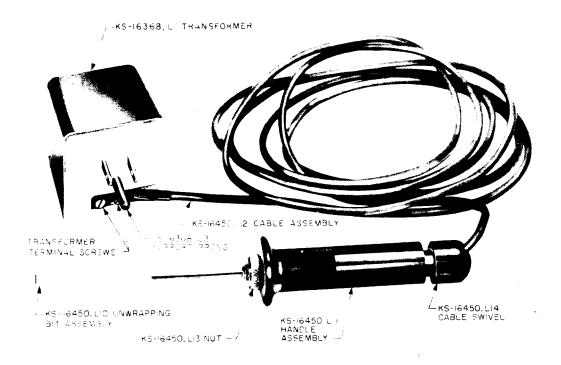
Fig. 1—♦KS-16450 L1 Wire Unwrapping Tool
