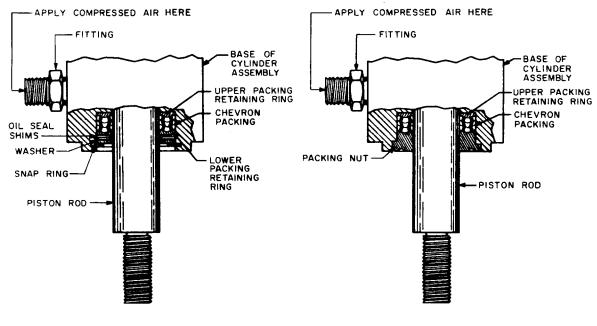
FIG. 2IA- CYLINDER FURNISHED INITIALLY-UPPER TUBING ON SIDE OF CYLINDER.
