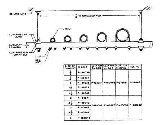
Fig. 23 - Conduit Support for One Tier of Conduit
