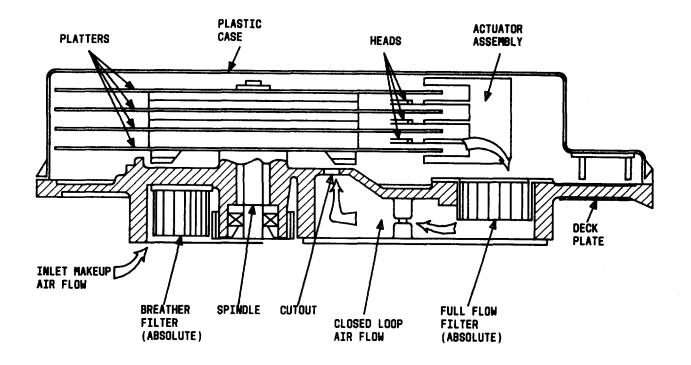
Fig. 5-Mini-Module Assembly
