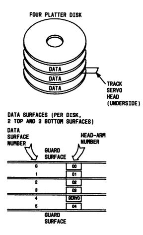
Fig. 3-Four-Platter Disk Layout
