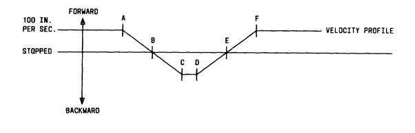
EVENT VELOCITY PROFILE POSITION STEADY SPEED PERIOD UP TO POINT A FORWARD MOTION DECELERATION A-B TAPE MOTION STOPPED MOMENTARILY 8 REVERSE MOTION ACCELERATION B-C FULL SPEED REVERSE MOTION C-D **REVERSE MOTION DECELERATION** D-E TAPE MOTION STOPPED MOMENTARILY E FORWARD MOTION ACCELERATION E-F STEADY SPEED FORWARD THROUGH DATA BLOCK N + 1 POINT F AND ON
