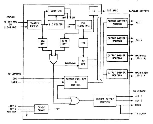
Fig. 7 - AHG16 Block Diagram
