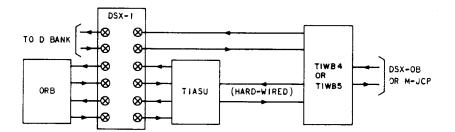
C. TYPICAL CROSS-CONNECTION FOR TI LINE USING COMBINED DATA-VOICE OPERATION
