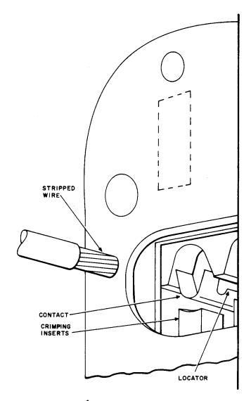
Fig. 14—Socket Hand Crimp Tool
