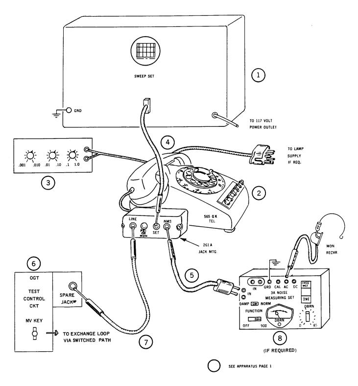
\* BRIDGE TIP OF SPARE JACK TO BOTTOM LUG LEFT SIDE OF KEY
