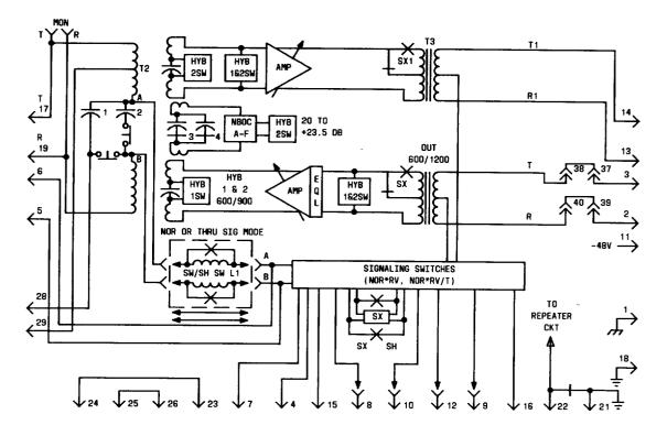
Fig. 1—J99343RA-1, L4 Block Diagram
