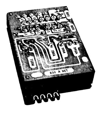
Fig. 1—830A Line Build-out Network
