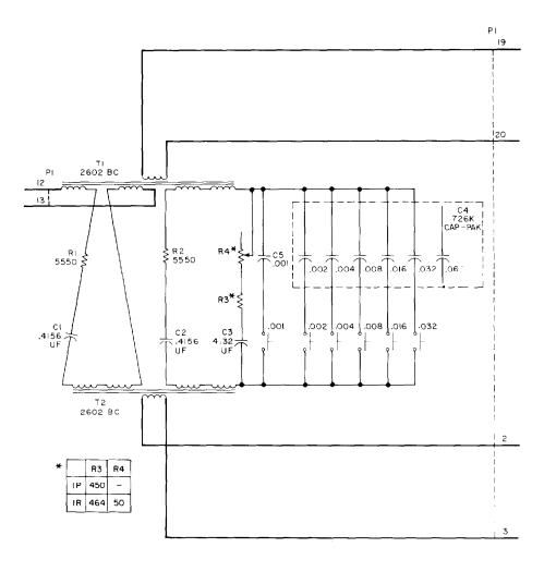
Fig. 2—1P/1R Terminating Set Schematic
