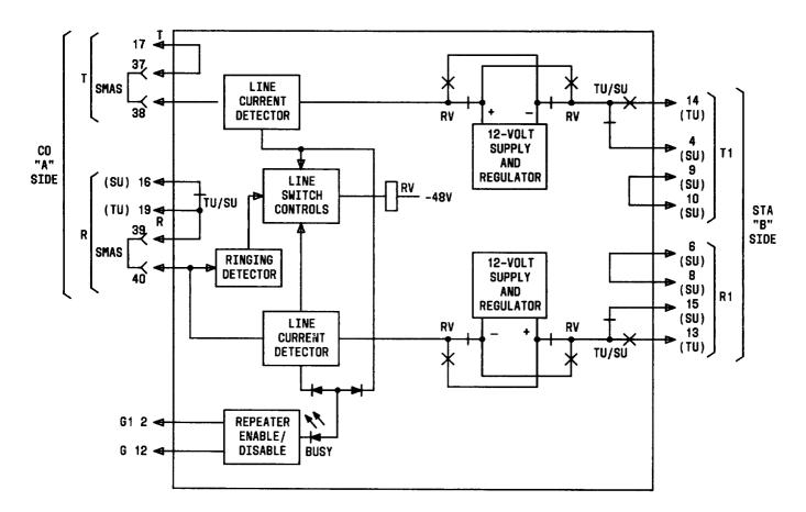
Fig. 16—Block Diagram of J99343CE LSE Unit
