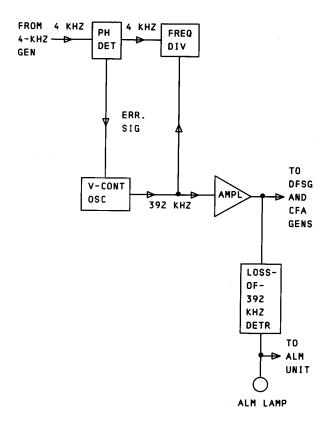
Fig. 13—392-kHz Generator—Block Diagram
