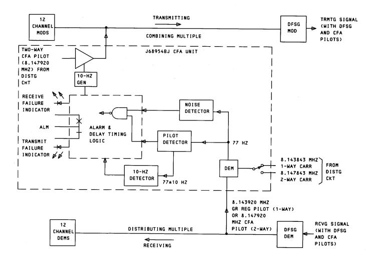
Fig. 5—CFA Unit—Block Diagram
