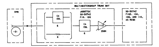
8 - HIGH-LEVEL ZERO-LOSS TRUNK CIRCUIT
