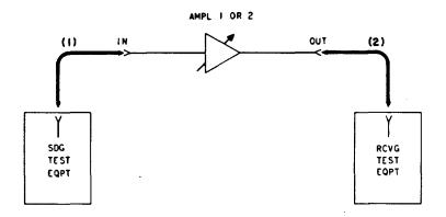
A-AMPLIFIER TEST CIRCUIT
