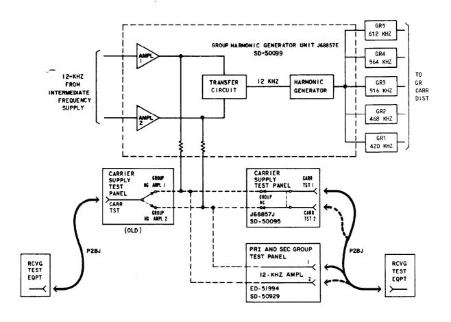
Fig. 4—12-kHz Amplifier Output Power Test
