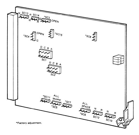
♦ Figure 5-9 DS2 INF Unit (Grp: 0A01/0B00) Straps Location (Sheet 1 of 2) ♦
