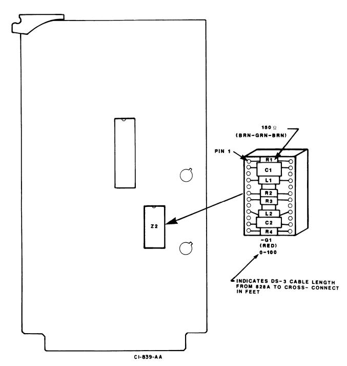
Figure 2E-5. Build-Out Module Orientation
