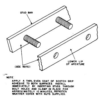
Fig. 11—Insertion of Stud Bar
