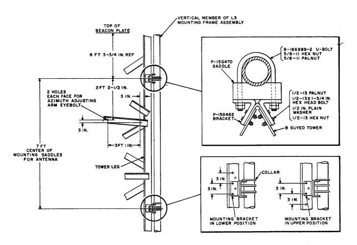
Fig. 15—Antenna Installation on AT-7728 B Guyed Tower
