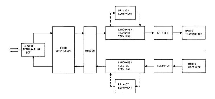
Fig. 3-Radiotelephone Terminal Arrangement
