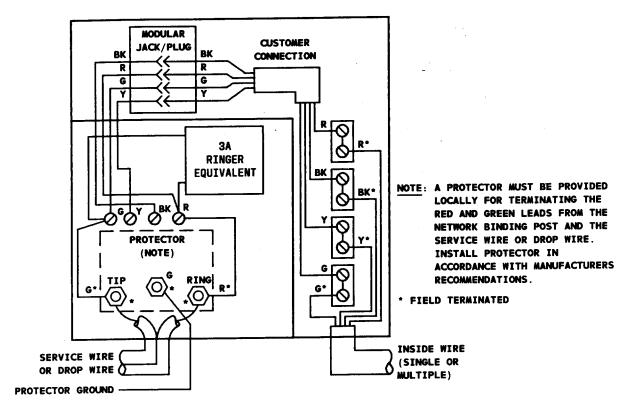
Fig. 4—100B1-1 NIU—Wiring Diagram
