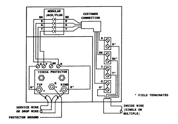
Fig. 3—100A1E-1 NIU—Wiring Diagram
