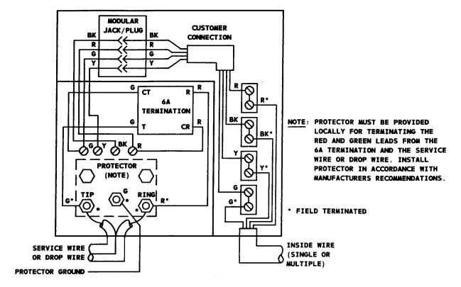
Fig. 6—100C1-1 NIU—Wiring Diagram
