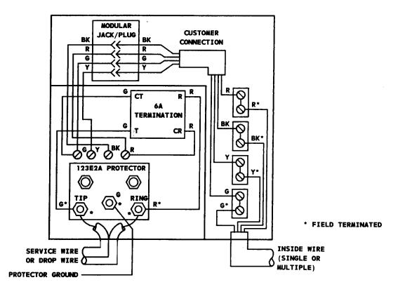
Fig. 7—100C1E1-1 NIU—Wiring Diagram
