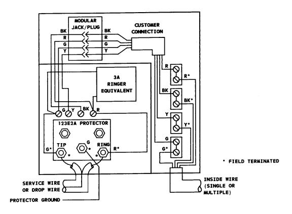
Fig. 5—100B1E1-1 NIU—Wiring Diagram
