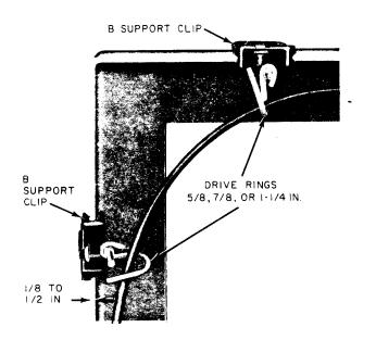
Fig. 26—♦B Beam Clips♦
