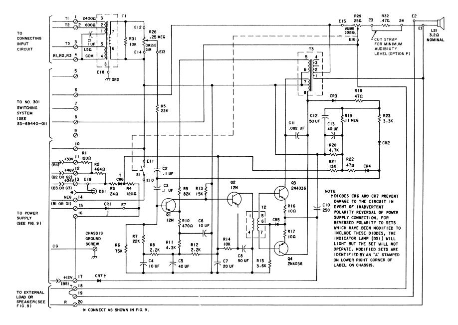
Fig. 14—Schematic—106F Loudspeaker Set
