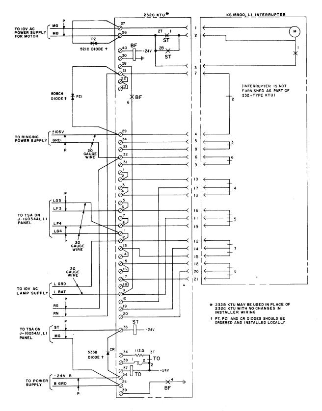
Fig. 6—♦Interrupter Circuit, 232C KTU♦
