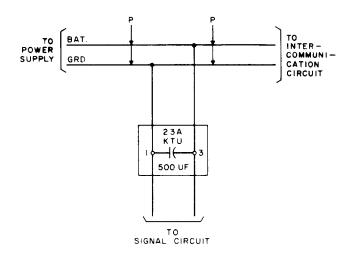
Fig. 20—Noise Suppression Filter Connections
