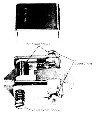
Fig. 6—₱KS-8108L2, KS-8109L2, or KS-8110L2 Buzzer♥
