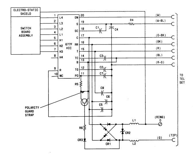
♦Fig. 14—Z72JG3AE Dial, Schematic♦
