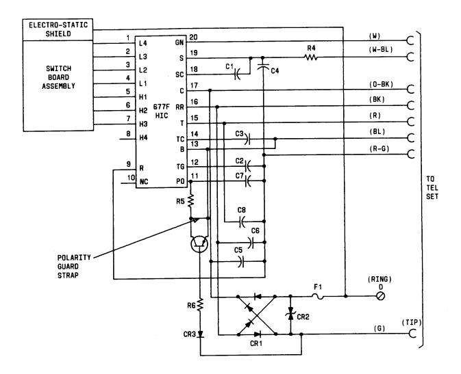
♦Fig. 13—Z72JG3A Dial, Schematic♦
