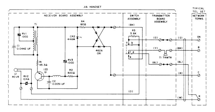
Fig. 3—♦J1A Handset, Schematic Diagram♥
