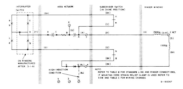
Fig. 4—F1A Ringer, Schematic
