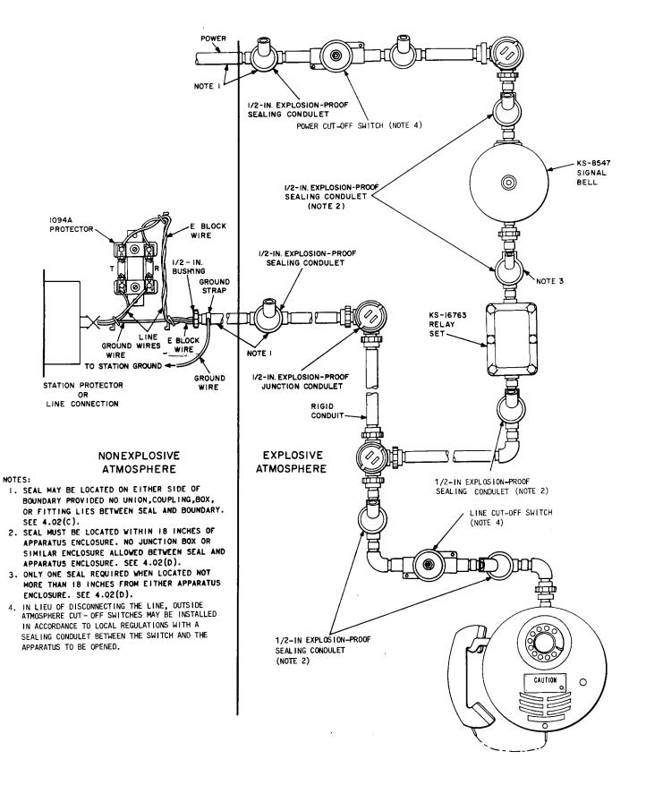
Fig. 6—Typical Conduit Arrangement
