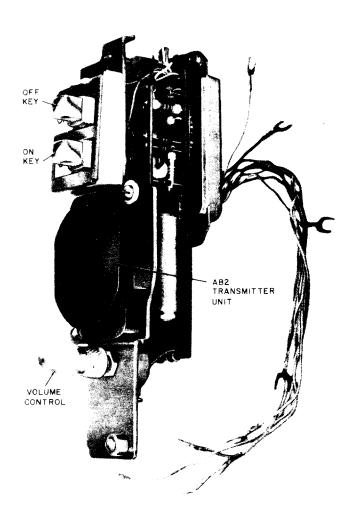
Fig. 22—667-Type Transmitter
