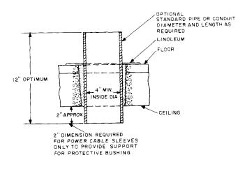
Fig. 2—Cable Sleeves
