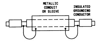
Fig. 4---Conduit Bonding
