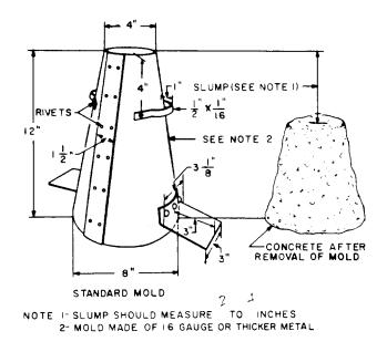
Fig. 5—Slump Test
