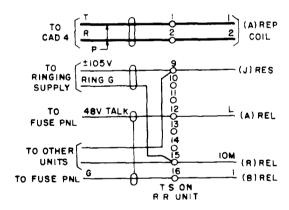
Fig. 17 - The 203-Type Terminal Strip
