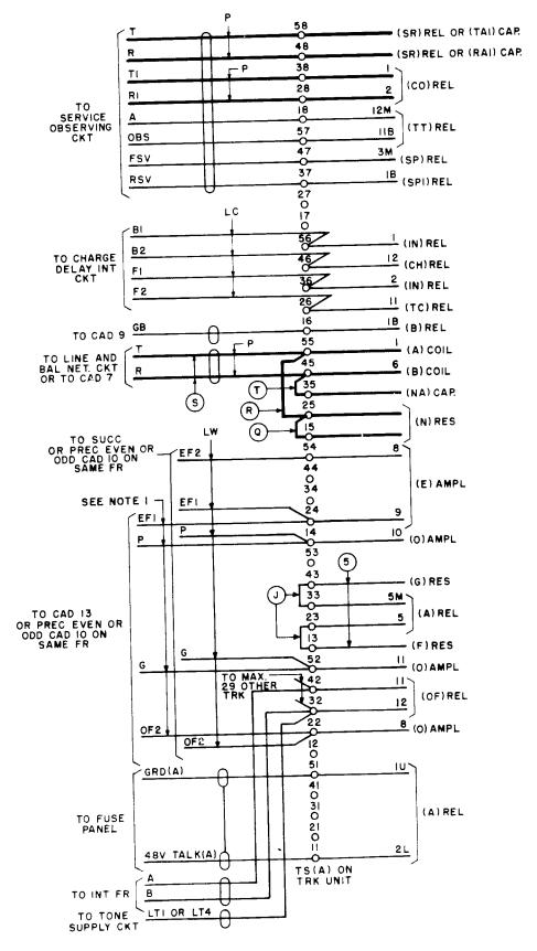
Fig. 21 - D-Type Terminal Strip
